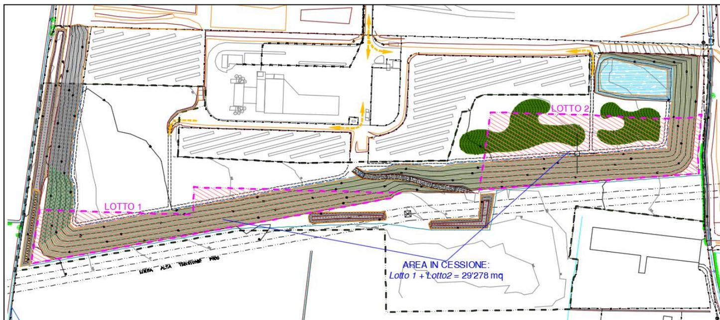
Figura 9: Cava I11-Beton - Sovrapposizione aree di cessione (Tav. 9) e planimetria di sistemazione (Tav.7).
