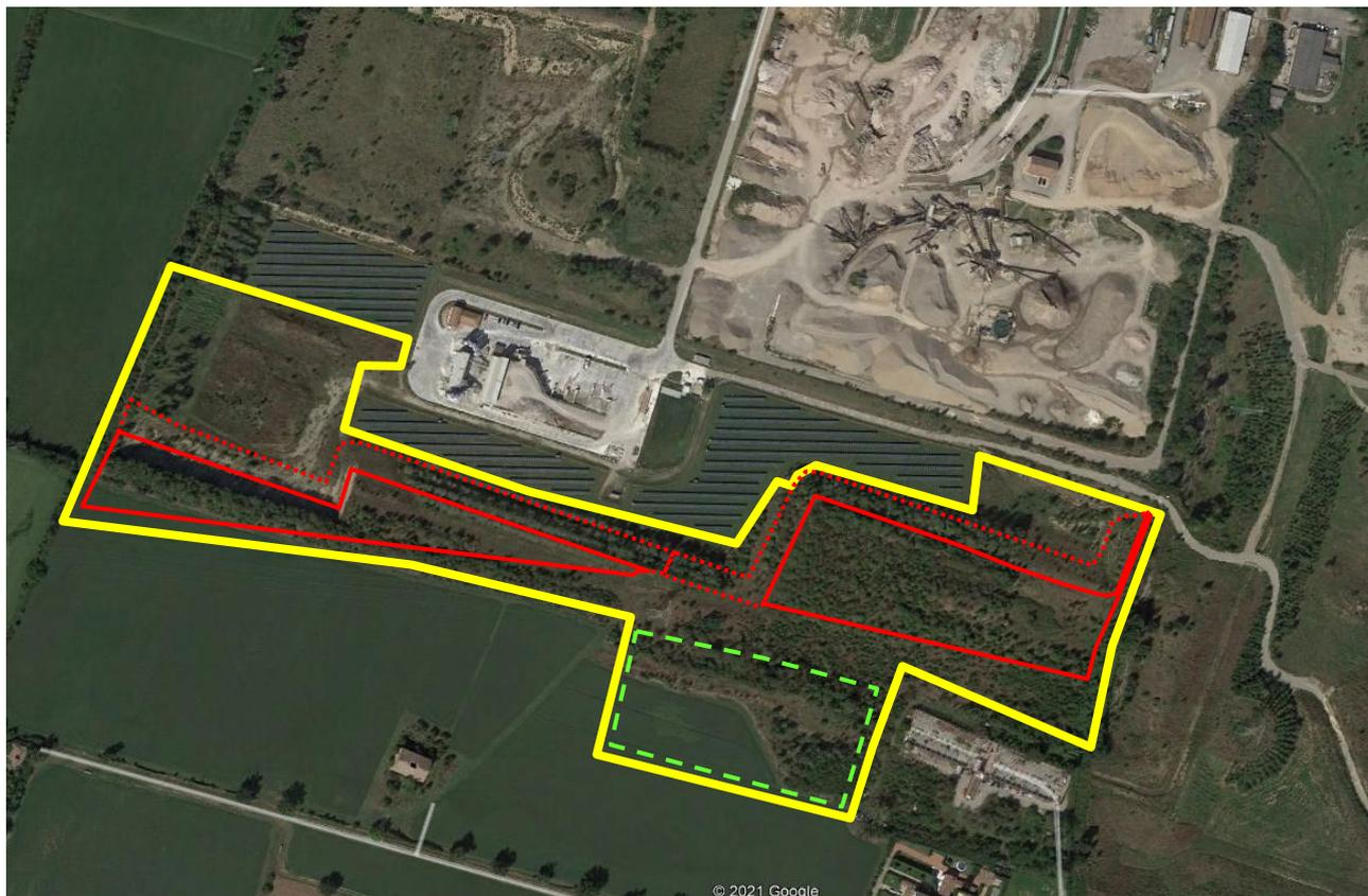
Figura 2: Inquadramento dell'area di intervento (contorno giallo); in contorno rosso l'area di scavo, in contorno verde l'area di servizio ricompresa a piano campagna per l'eventuale stoccaggio temporaneo delle terre – Foto satellitare (©2021 Google Earth)
