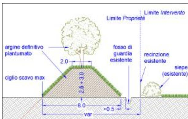
Figura 11: Particolare costruttivo (PC); schema minimo di realizzazione dell'argine di mitigazione definitivo, per la riqualificazione ambientale e visiva dell'area, da realizzare a ovest.
