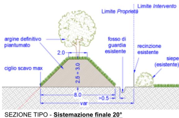
Figura 10: Particolari costruttivi (PC); a sinistra l'argine di mitigazione definitivo, per la riqualificazione ambientale e visiva dell'area, da realizzare a ovest; sotto lo schema di rivestimento delle scarpate di scavo, a sinistra il fronte di ripristino verso ovest, a destra lo schema di rinfilo delle eventuali scarpate provvisorie che si verrebbero a configurare in direzione nord e/o sud qualora non fosse possibile lo sfondamento dei setti in continuità con i settori adiacenti.
