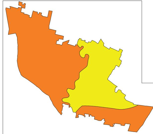
Suddivisione dell'area comunale di Formigine (MO) secondo gli Ambiti individuati nell'Atto di Indirizzo e Coordinamento Tecnico n. 112/2007 ai fini dell'applicazione delle tabelle contenute nell'allegato A2 utili per il calcolo dei Coefficienti di Amplificazione.
