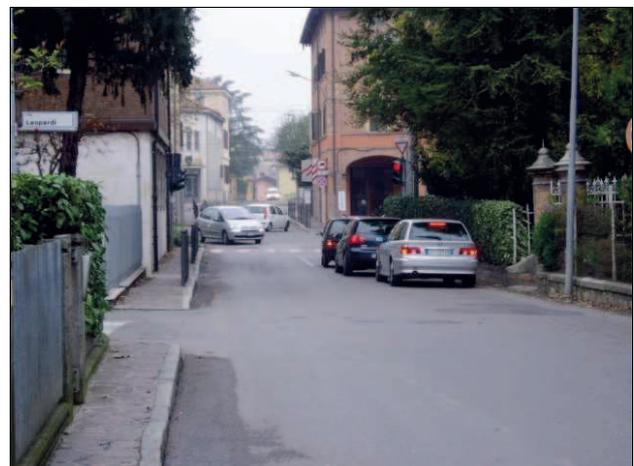
*I fittoni parapedoni su un marciapiede di larghezza insufficiente costituiscono una protezione minima per il pedone, considerato il transito elevato della strada in questione, ma impediscono la percorribilità da parte di sedie a ruote e passeggini.*
